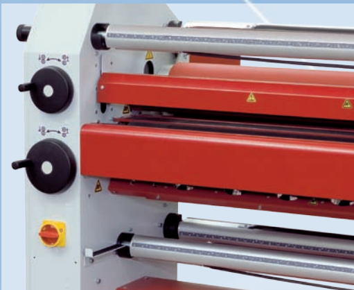
Alle Kaschiermaschinen sind mit Autogrip-Achsen für einen schnellen Materialwechsel ausgestattet
